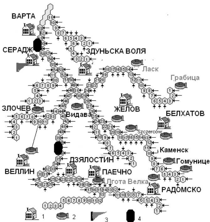
Рис. 4.2.1. Интерфейс программы управления реки Варты с водохранилищем Езерско и притоками Пихна, Грабия, Олешница, Видавка, Красувка и Жеглина. 1 – точный источник бытовых и промышленных стоков, 2 – очистное сооружение, 3 – небольшое водохранилище на водосборе, 4 – польдер
